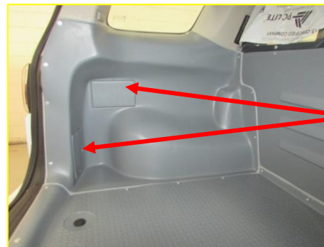
TAMPAS DE INSPEÇÃO DAS CONEXÕES DA LATERAL ESQUERDA
