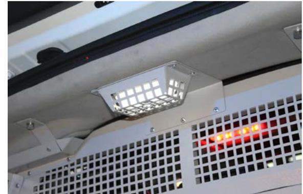
Os Revestimentos Laterais são fixados através de rebites de alumínio do tipo Pop sobre os acabamentos originais do porta-malas. É fixado sobre revestimento o original, possui Drenos e Compartimento para o Estepe.
