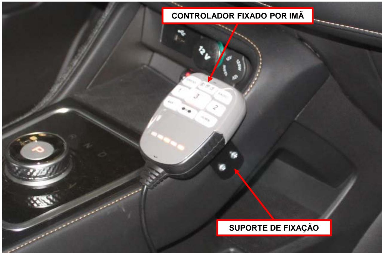
O veículo é equipado com Rádio Comunicador modelo Motorola DGM 8000e VHF / FM, com chicotes instalados e passados juntamente com os chicotes originais do cofre do motor e painel interno, sendo alimentado pela bateria original 12V. É fixado no painel através de um suporte de aço SAE 1020 com pintura eletrostática preta.
