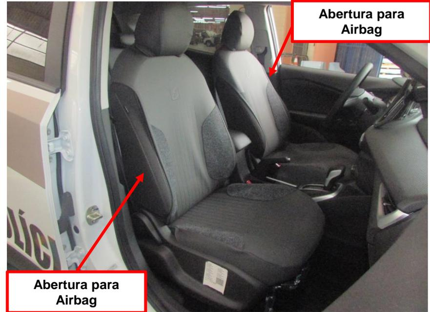
Capas removíveis adicionais de revestimento dos bancos lavável, flexível e impermeável, com reforços na região de cintos e armas.
