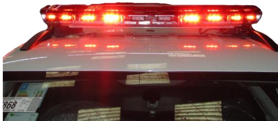
O Sinalizador modelo Max Pegasus II é instalado no teto, possui formato de arco e permite a visualização das luzes em 360°. É construído em estrutura de Policarbonato injetado nas cores Cristal e Rubi com base em perfil de alumínio extrudado. Possui um conjunto de 20 módulos de LED's na cor Rubi com 3 Watts de potência para cada LED, distribuídos equitativamente por toda a extensão da barra de forma a permitir total visualização.
