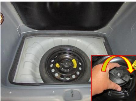
\*Reposicionar a roda sobressalente e prendê-lo ao recesso com um manípulo de fixação girando no sentido horário.
