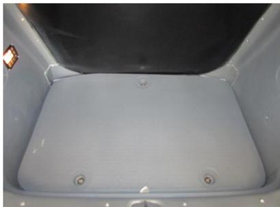
\*O pneu reserva está localizado no compartimento do detentos, sob o revestimento do assoalho. Ele é preso ao recesso com uma porca borboleta.
