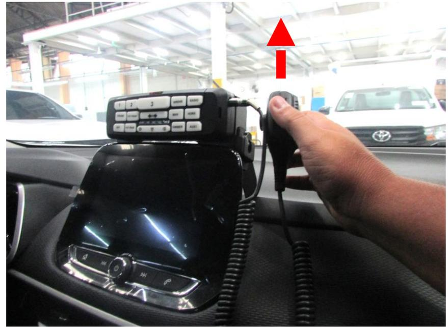
O sistema de sinalização visual e acústica é comandado através do Painel de Comandos Maxfinder instalado na parte superior central do painel do veículo, de forma a oferecer acesso rápido e melhor ergonomia para sua utilização. É fixado atrás da Central Multimídia por meio de parafusos philips. Possui um microfone fixado lateralmente em um suporte original do Kit.
