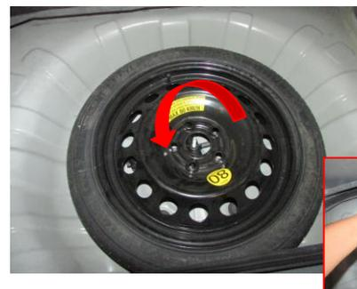
\*Desapertar o manípulo de fixação girando no sentido anti-horário. Retirar a roda sobressalente.
