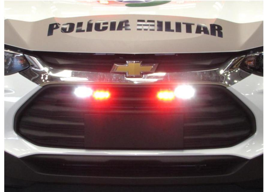
Os Sinalizadores Dianteiros modelos Micro Dmax 4x1, estão instalados na grade do para-choque dianteiro, possuem tecnologia LED nas cores **Branca** e **Rubi** e possuem estrutura em alumínio injetado com pintura eletrostática preta, sendo fixados em suportes de alumínio com parafusos M4, arruelas lisas M4 e porcas auto-travantes M4.
