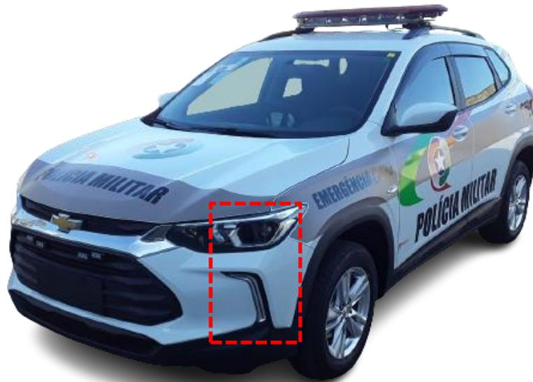
Adequadamente instalado na lâmina lateral esquerda, localizada na parte interna do para-choque, reproduz o som do amplificador.
