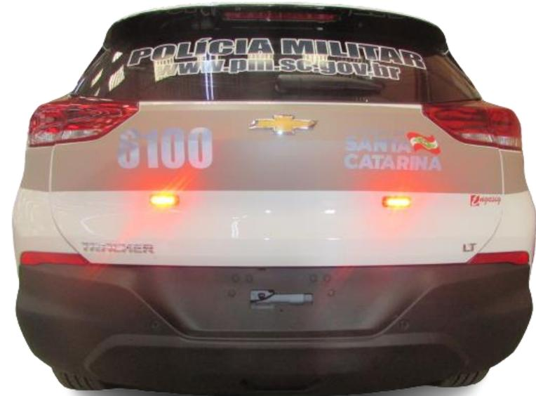
Os Sinalizadores Traseiros modelos Micro Dmax 4X1, estão instalados na região externa inferior da tampa do porta-malas, possuem tecnologia LED na cor **Rubi** e estrutura em alumínio injetado com pintura eletrostática preta, sendo fixados na lataria com parafusos A.A Philips.
