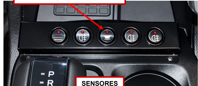
BOTÃO DE ACIONAMENTO DA LUMINÁRIA
