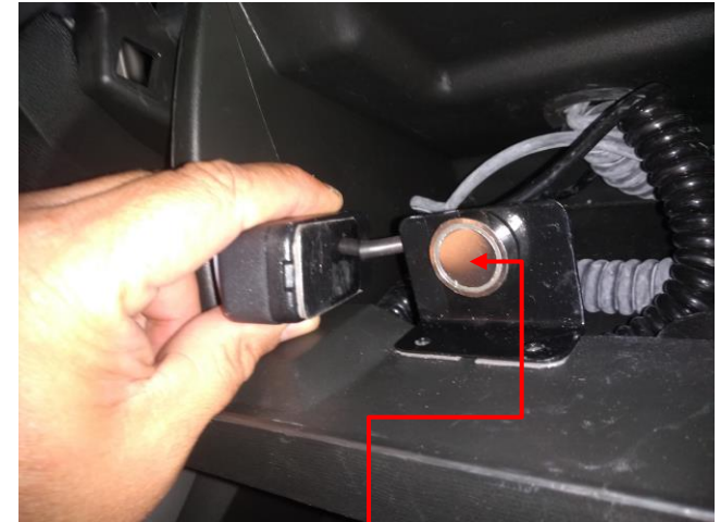
Fixador Magnético na parte interna do porta luvas
